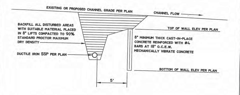
EROSION CUTOFF WALL TYPICAL SECTION
